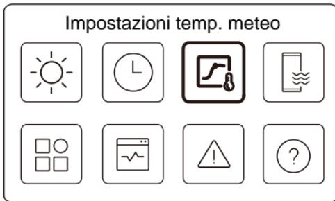
La temperatura dell'acqua impostata viene regolata automaticamente in base alla temp. ambiente esterna.
